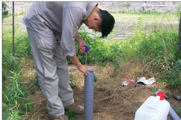
현장투수 시험 및 수위 측정
